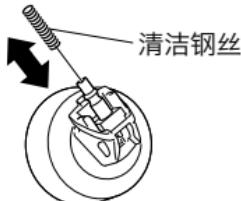
●移动时，请让清洁钢丝的尖端从碳酸喷嘴中伸出。根据角度，清洁钢丝可能会接触到化妆品喷嘴。请不要用力戳碰。
